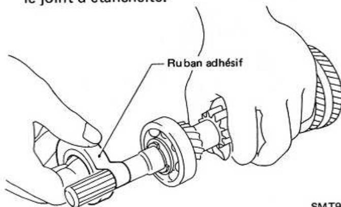
7. Mettre l'ensemble d'arbre primaire accouplé à l'ensemble de fourchette de sélection et à l'ensemble d'arbre d'attaque en place.
